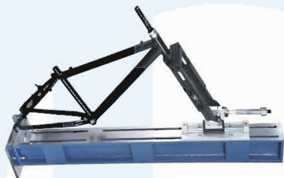
DBG008-A Frame Horizontal Fatigue Test
